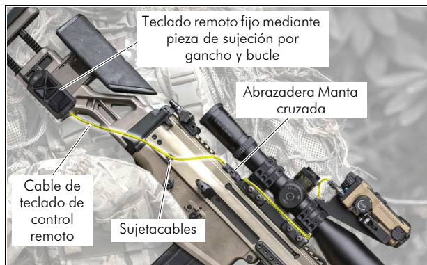
Fig. 6.i - Disposición del cable recomendada
