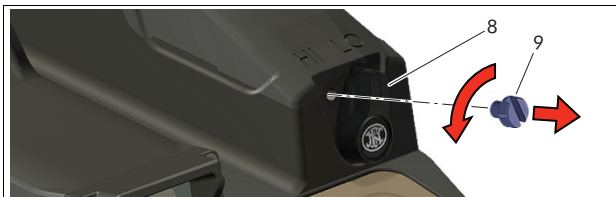
Fig. 3.l - Ajuste del selector de potencia del puntero a modo de potencia alta (HI)
