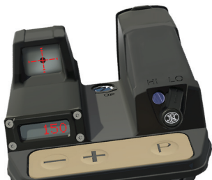
Fig. 3.p - FN® FCU Mk3 inclinée vers la gauche, réticule clignotant rapidement
