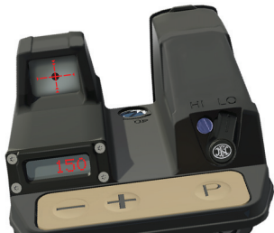
Fig. 3.p - La FN® FCU Mk3 presenta canteo hacia la izquierda; el retículo se muestra con intermitencia rápida.
